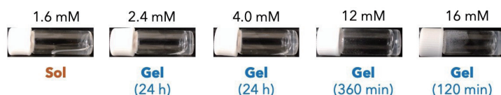
図3 ヒドロゲル形成能から評価したFmoc-C CF 3 Bzl の水溶液中における分子集合挙動.
