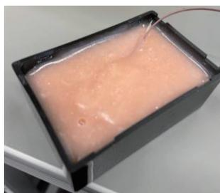
図3 ノルマルパラフィンマイクロカプセルを適用した供試体。
