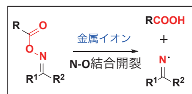
図1 金属イオンによるオキシムエステルのN–O結合開裂反応。
