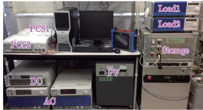
図 3. 蓄電池によるモードスイッチング制御の実験的検証に向けた研究室内シミュレータの外観. 文献 (3) より転載.
