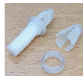
図 6. 担体把持部の 3D プリンティング結果。
