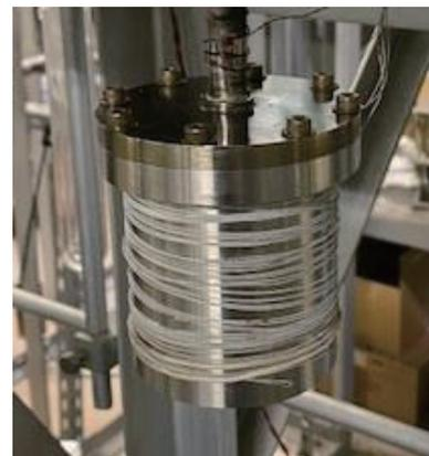
図2 高温熱伝導率測定装置の外観。
