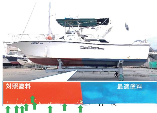
図2 本研究で行った実船舶での塗料の評価試験。
