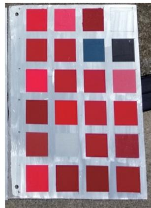
図1 沖縄県での試験に使用したプレート。
