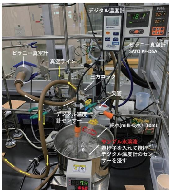
図6 平衡水蒸気測定装置<sup>30)</sup>。
