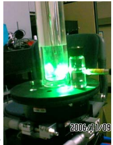
Xe-ベンゼンハイドレートのラマン分光 (豊田中研との共同研究)
