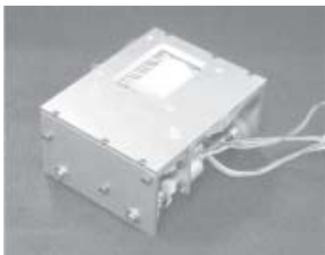
図 3. フィルムと回転体を用いた滑り感覚ディスプレイ.
