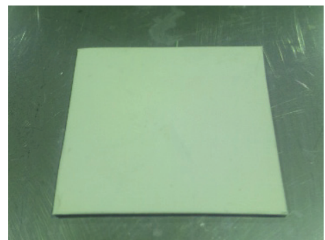
図 1. iPP/MgO コンポジットの外観
