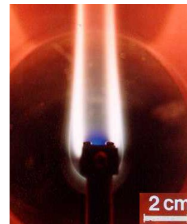
図 1 He ガス中での Cu の蒸発により生成される超微粒子の煙
