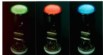
図5 CNT電界エミッタを用いた高電圧蛍光表示管
