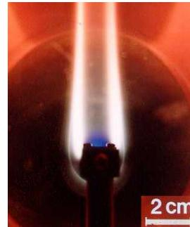
図1 Heガス中のCuの蒸発により生成される超微粒子の煙
