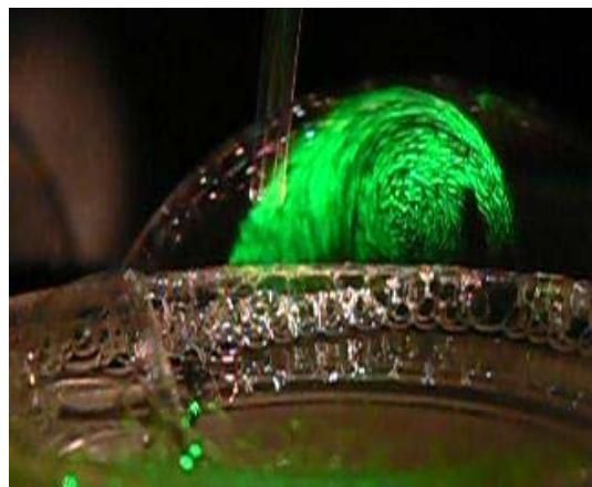
1、左図：シャボン玉(北半球)にペン型低圧水銀燈を数秒点灯する。右図：数秒の照射後に生成した水滴。シート状にしたレーザー光による光散乱で観測したもの。
