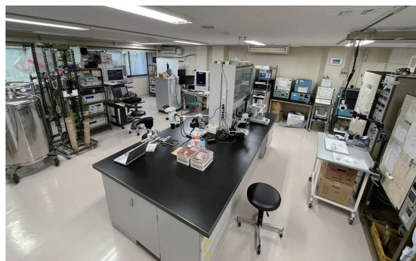
図13 豊田理研—京大連携拠点（TRiKUC）の新しい実験室。 左端からヘリウム3冷凍機と測定システム、精密磁化測定システム（QD社, MPMS）、粉末X線回折装置、ラウエ装置、各種電気炉、右端は2台の単結晶育成用フローティングゾーン炉（FZ炉）。
