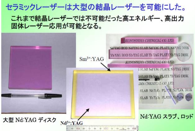
図 9:ガラスと結晶の利点を併せ持つセラミックレーザー
