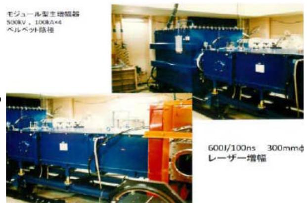
図 1:電子ビーム励起 KrF レーザー増幅器
