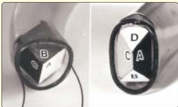
コイル先端にある触媒粒の結晶面モデル
